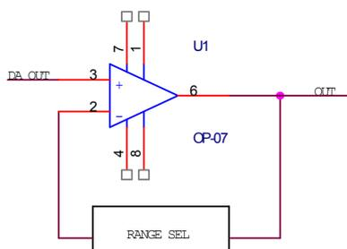
DA 输出信号到缓冲放大器，同时将 DA 输出的信号变换为 5、10 伏、±5 伏信号。由于运算放大器输出**无法驱动电容、电感负载**，因此应用时如果驱动类似负载，请在输出与被驱动设备中间串联一个 100 欧姆到 500 欧姆的电阻。DA 输出为静态低速信号，适合作为控制信号，不适合输出波形信号。
