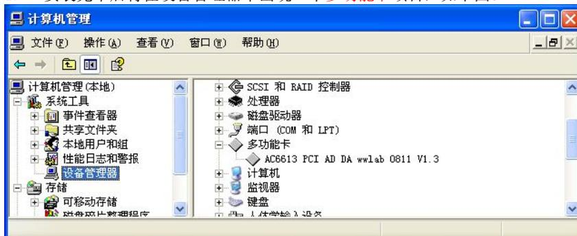
2. 如果需要更新设备驱动，请在硬件设备管理目录下选择AC6613卡 -> 按鼠标右键选择属性 -> 选择驱动程序 -> 选择重新安装驱动程序。
